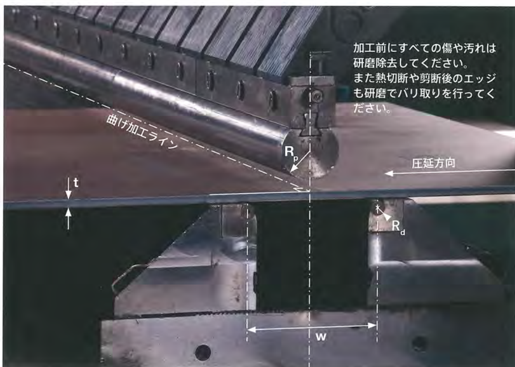
図 1 : 圧延方向に対して直角曲げの例
